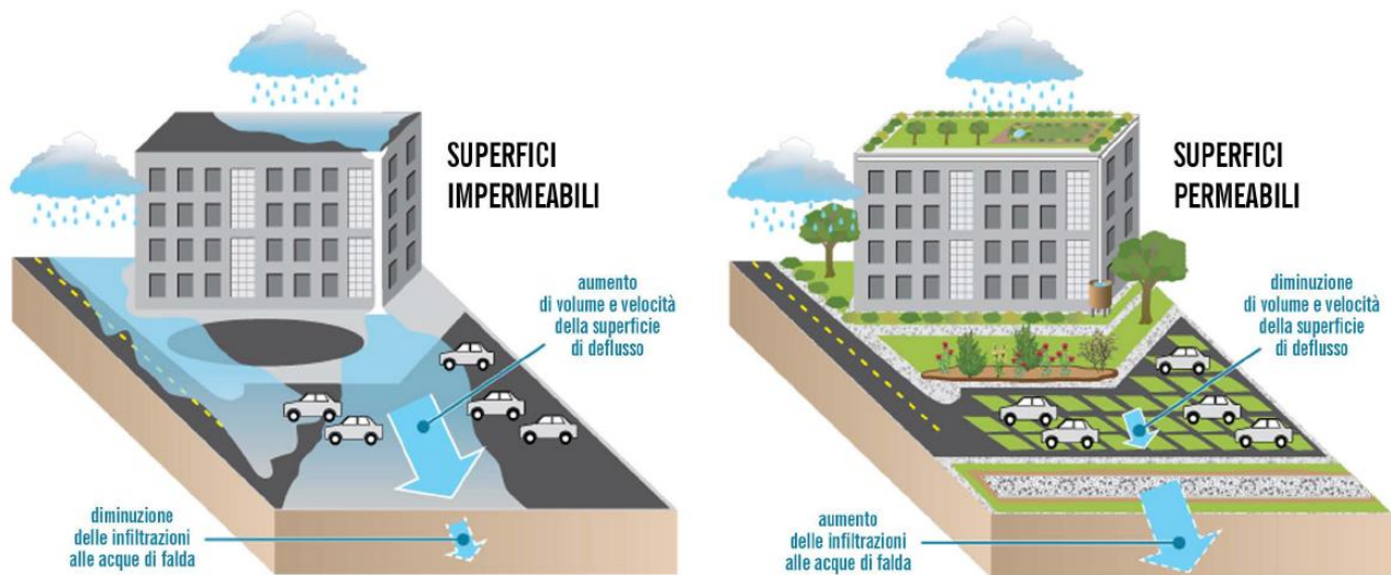
fig. 7 Invarianza idraulica: gestione delle acque pluviali
