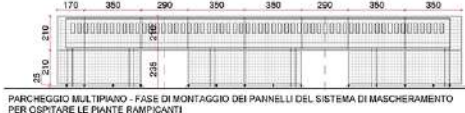
PARCHEGGIO MULTIPIANO - FASE DI MONTAGGIO DEI PANNELLI DEL SISTEMA DI MASCHERAMENTO PER OSPITARE LE PIANTE RAMPICANTI
