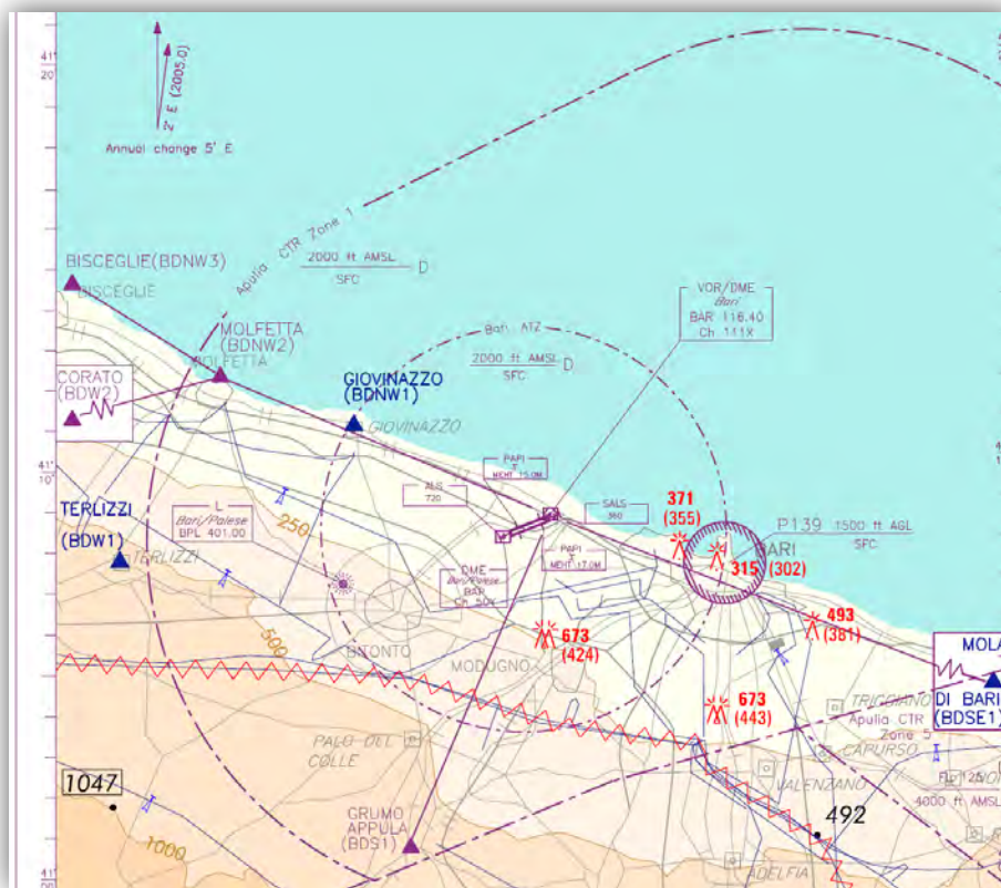
Figura 102. Zona ATZ e Zona CTR che interessano il territorio comunale. Stralcio Carta ICAO – VISUAL APPROACH CHART (fonte ENAV – Roma)
